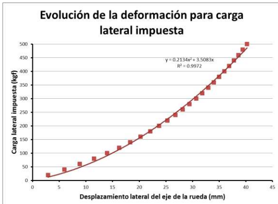
Figura 7: Evolución de la deformación lateral para el caso de estudio de neumático cruzado bajo carga vertical y horizontal de 500 kgf y 28 lbf/pulg 2 de presión de inflado
