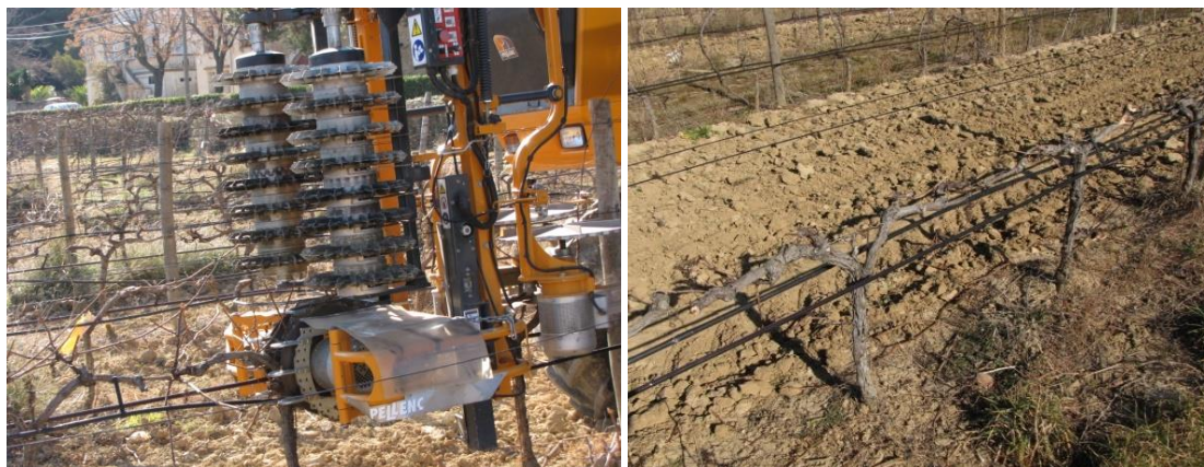
Figura 2. Poda rasa de precisión con implemento de corte circular. INRA Pech Rouge, Francia.
