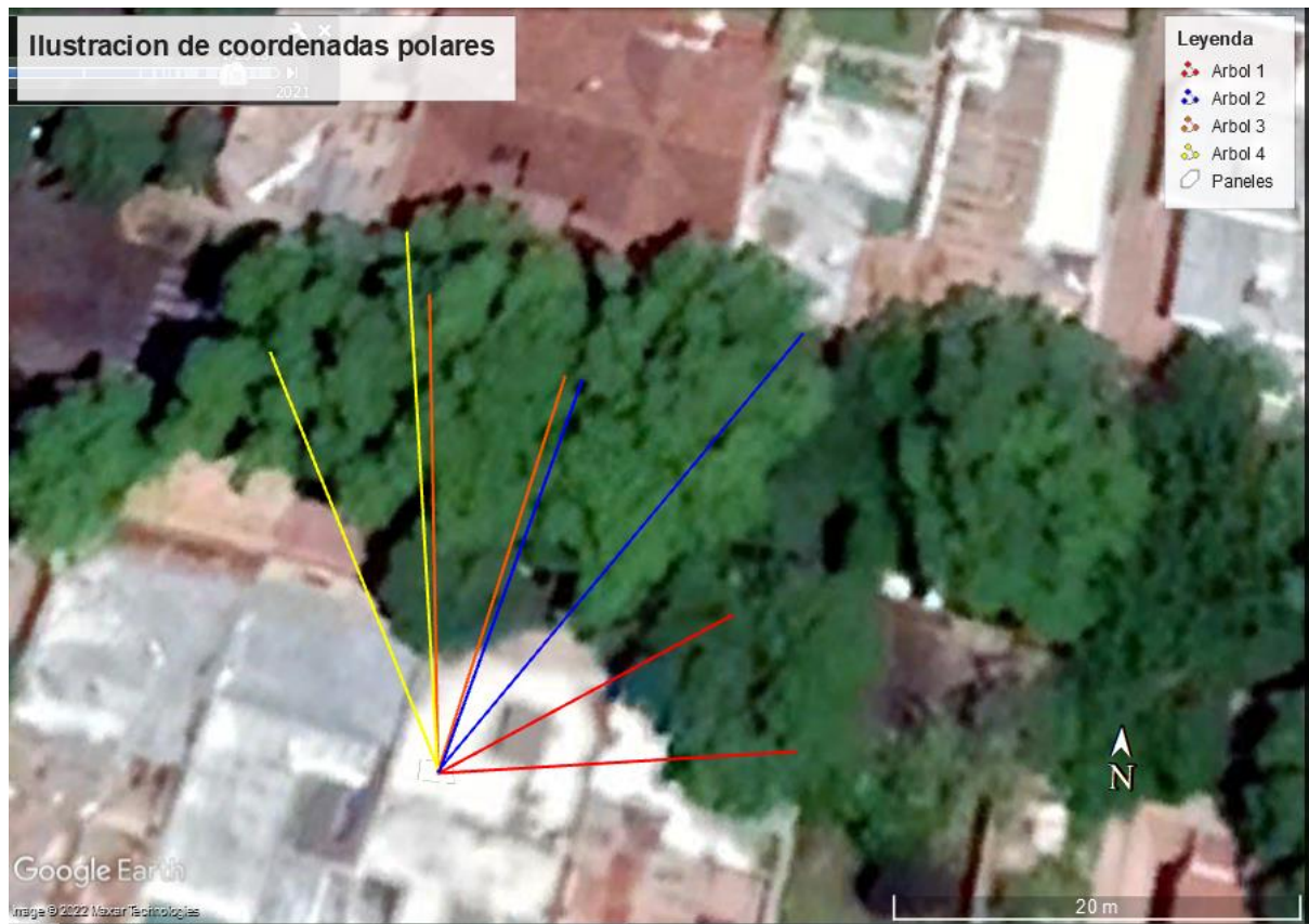
Figura N°28: Imagen satelital donde se señalan las coordenadas polares de los obstáculos que presenta el área de estudio. (Fuente: Elaboración propia con la herramienta Google Earth).
