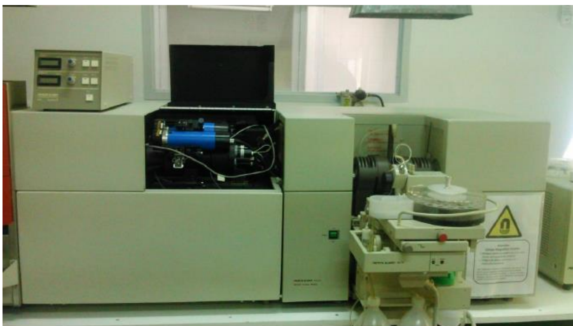
Fig. 2.2.1. Espectrómetro de absorción atómica Perkin Elmer 5100 PC utilizado a lo largo de la presente Tesis.
