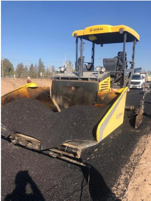
Ilustración 53: Terminadora de asfalto
