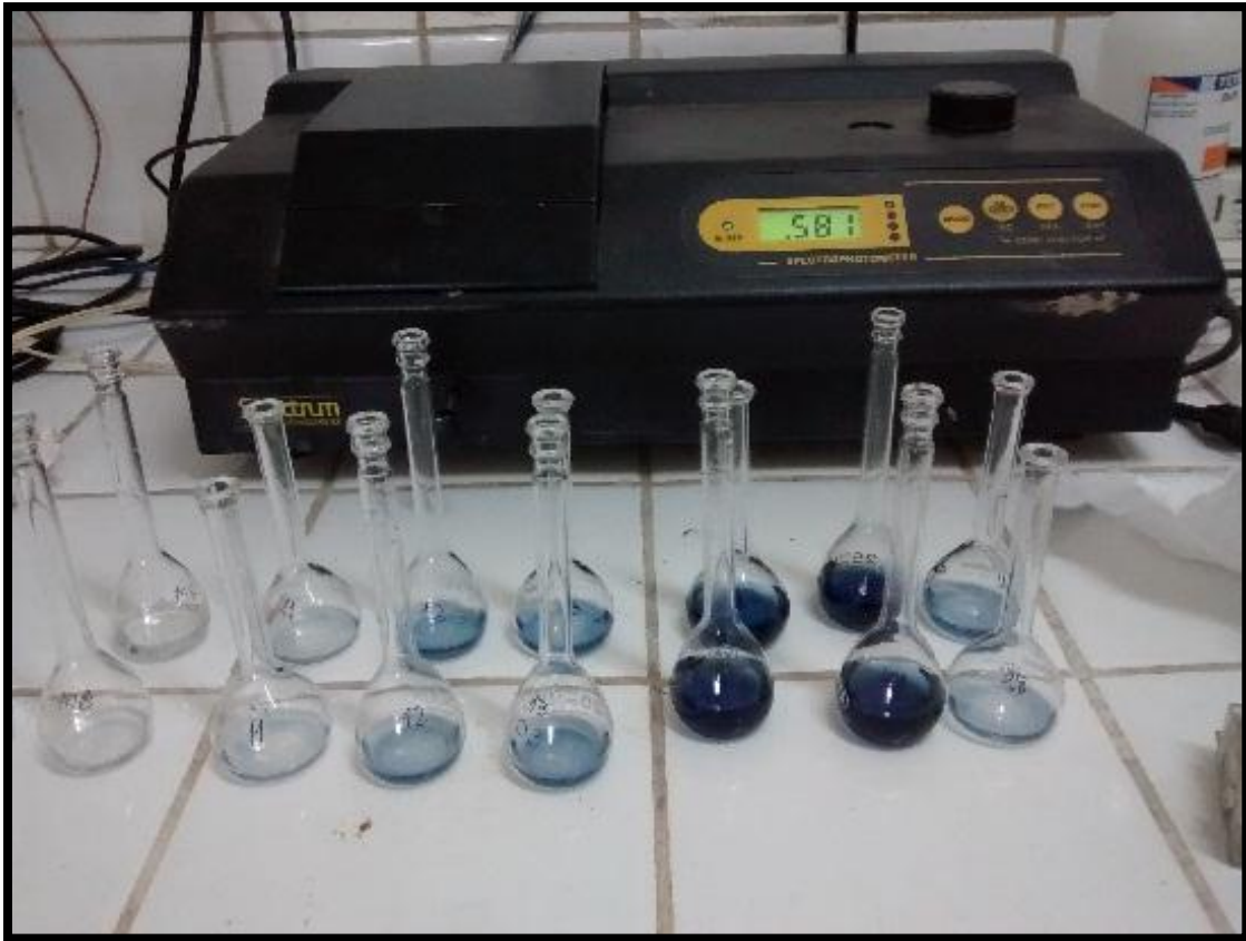
Figura 14: Medición de fósforo solubilizado en medio líquido por espectrofotometría. Cada par de matraces corresponde a una cepa bacteriana, la intensidad de color es proporcional a la concentración de fósforo en solución.
