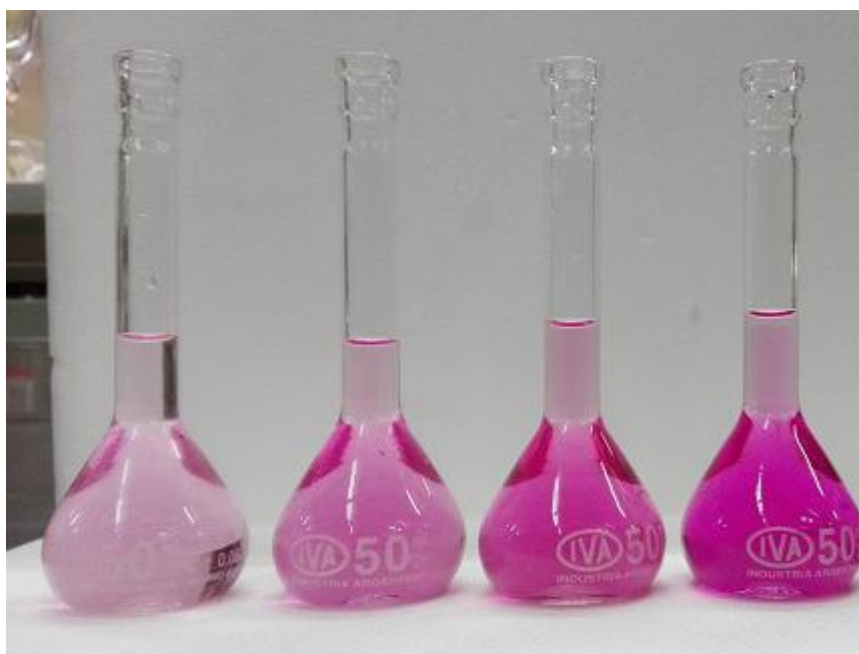
Figura 15: Coloración adquirida en la preparación de los cuatro puntos de la curva de calibración, de derecha a izquierda: 0,084 \text{ mg NO}_2\text{L}^{-1} ; 0,164 \text{ mg NO}_2\text{L}^{-1} ; 0,328 \text{ mg NO}_2\text{L}^{-1} y 0,657 \text{ mg NO}_2\text{L}^{-1} luego de formación de la solución coloreada azo púrpura rojiza.
